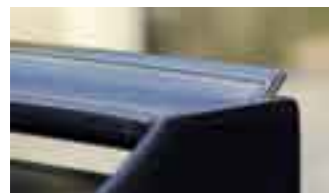
Ein gutes Blatt: Das steil im Wind stehende Heckflügelprofil aus Kohlefaser stammt vom legendären Sport-Evo
